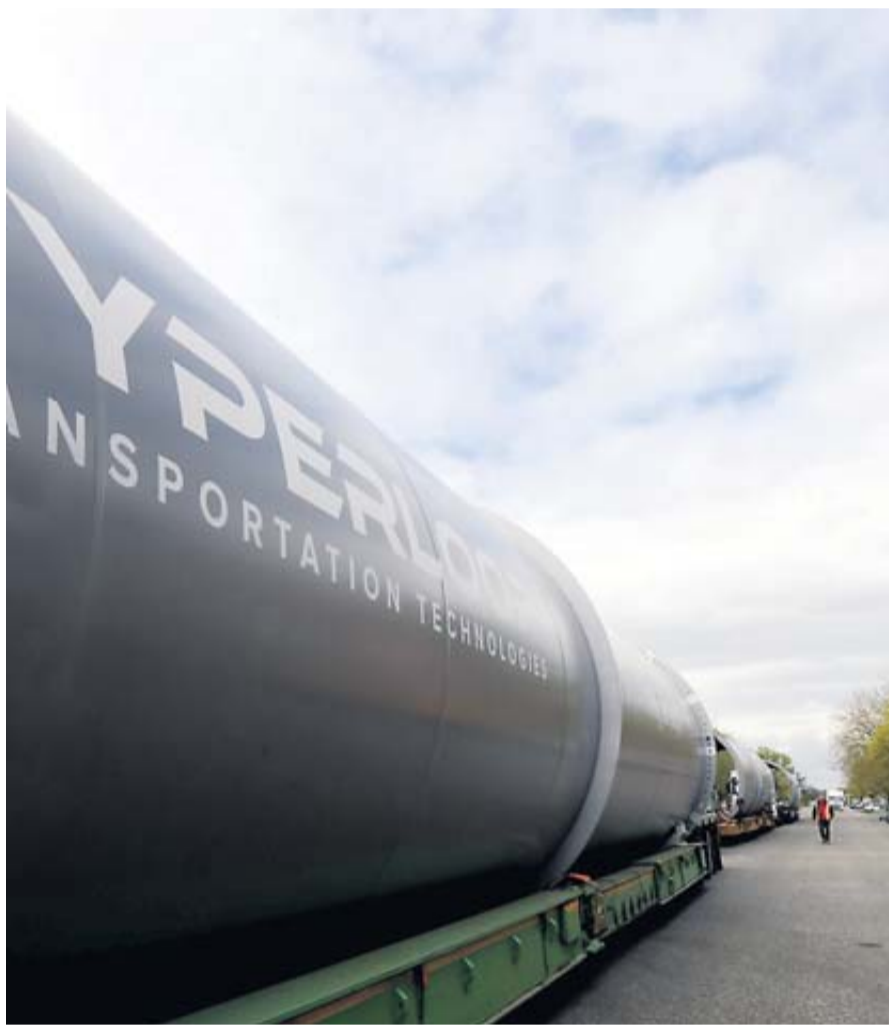
Fabriqués en Espagne, ces tubes mesurent 20 mètres de long et 4 mètres de haut. /DDM, N. St-Affre
